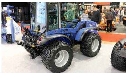
Mitas 440/50R17 IMP AR-04 na traktoru Volcan. Tyto radiální záběrové pneumatiky jsou mimořádně vhodné pro použití na loukách nebo na svazích a umožňují nejvyšší rychlost 65 km/h.
