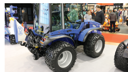
Pneus Mitas 440/50R17 IMP AR-04 equipados num trator Volcan. Estes pneus de tração são adequados para operações em prados ou declives e permitem alcançar velocidades de 65 km/h.
