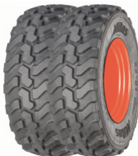
O EX-01, específico para escavadoras de rodas, é caracterizado por uma banda de rodagem não direcional e flancos reforçados.
